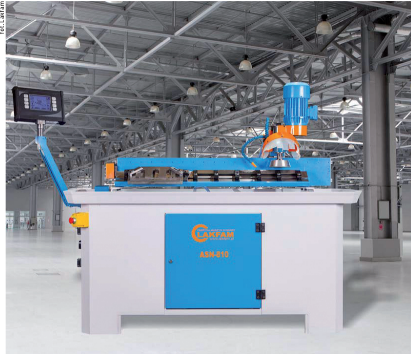
Od niedawna szlifierka ASN-810 produkowana jest w wersji specjalnej oznaczonej dodatkowym symbolem „A”. Jest to model rozbudowany o dodatkowy posuw poprzeczny głowicy szlifierskiej.
